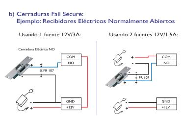
Importante: La longitud del cable entre el dispositivo y la fuente de poder debe ser menor a 3 metros.
